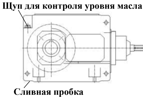
Рис. 6.4. Редуктор конвейера Рис. 6.5. Редуктор ходовой части
