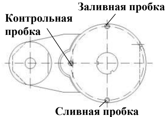
Рис. 6.4. Редуктор конвейера Рис. 6.5. Редуктор ходовой части
